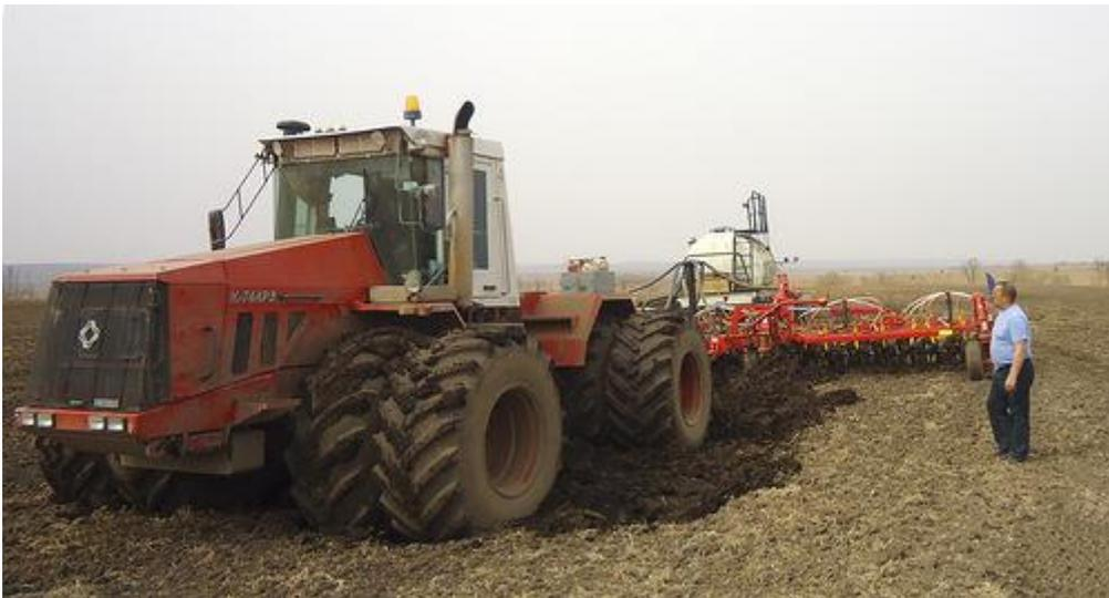
Трактор "Кировец" с 420-сильным двигателем Тутаевского моторного завода приобретен в 2013 году. На фото - во время посевной в агрегате с широкозахватным посевным комплексом Vorgault. Для полного использования всего запаса мощности турбодизеля трактор оснащен сдвоенными колесами и максимально забалластирован.
